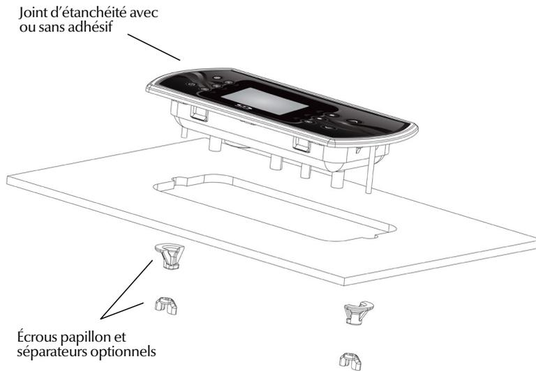
Pour installer le clavier in.k800, utilisez le modèle de perçage fourni dans cette section.
