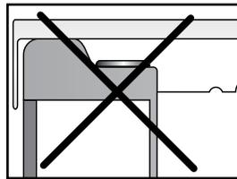
Le clavier in.k800 doit être installé sur le bord extérieur du spa, de sorte qu'il ne soit pas exposé à l'humidité coincée par le couvercle.
