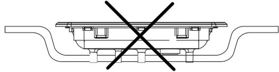
L'arrière du clavier in.k800 ne doit pas être enfermé dans un endroit où l'eau peut s'accumuler, mais plutôt laissé à découvert.
